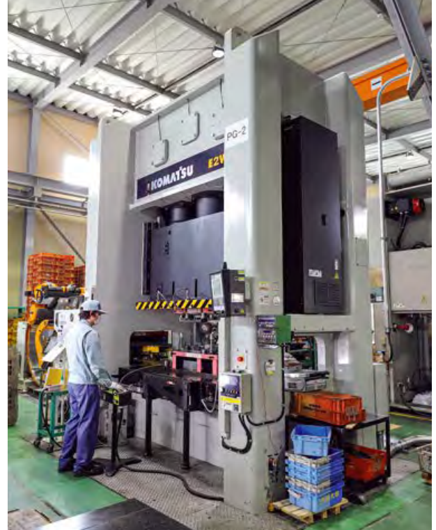
300tのプレス機を導入し、より高精度なモノづくりへ。
